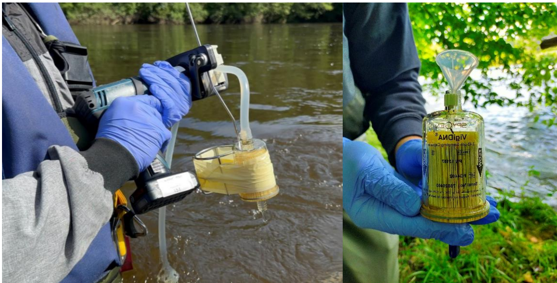
Figure 7 : Vampir Sampler prêt à filtrer (à gauche) et la capsule de filtration (à droite)
